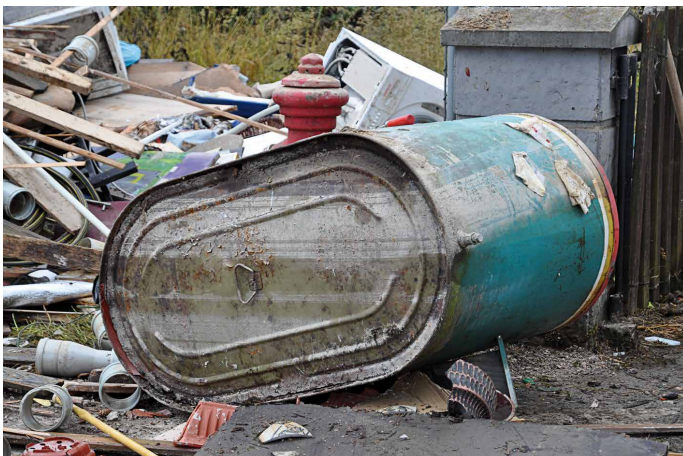
Abb. 1a + 1b: Durch eingedrungenes Wasser aufgeschwemmte Heizöltanks
