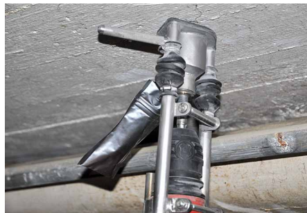
Abb. 7 a + b: Beprobung von Beton
