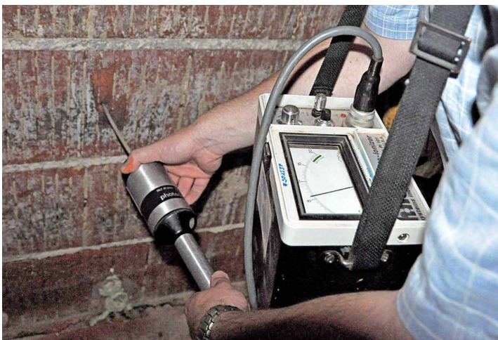
Abb. 5: Untersuchung mit dem Photoionisationsdetektor PID
